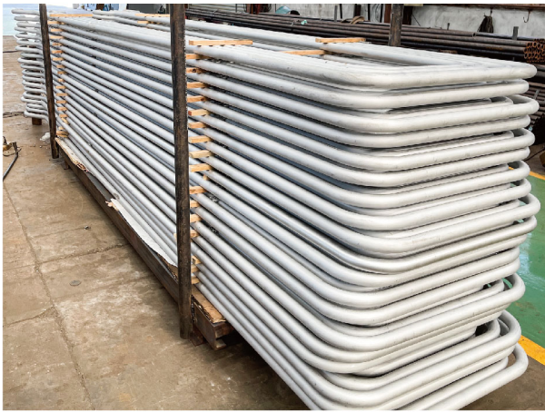
LNG main boiler superheater fabrication
